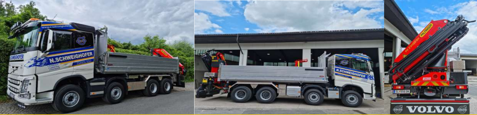
LKW 4-Achs-Kipperfahrzeug & Ladekran 23 m/to (variabel mit Greifer, Anhänger & Tieflader)
