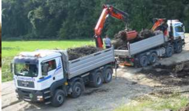
LKW 4-Achs-Kipperfahrzeug & Ladekran 23 m/to (variabel mit Greifer, Anhänger & Tieflader)
