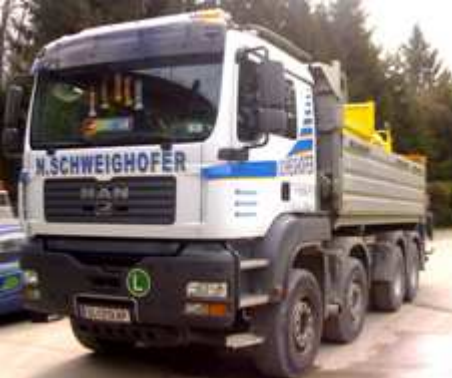
LKW 4-Achs-Kipperfahrzeug & Ladekran 23 m/to (variabel mit Greifer, Anhänger & Tieflader)
