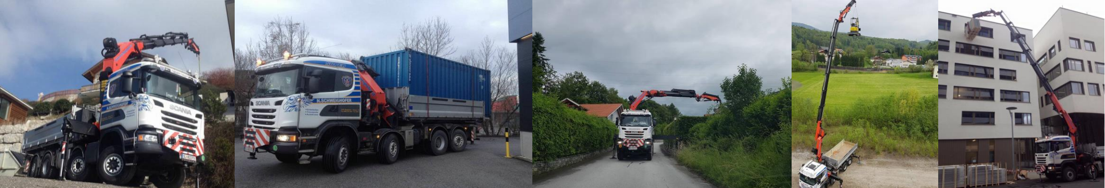
LKW 4- Achser & Ladekran 42 m/to + Jib (variabel mit Greifer & Tieflader)
